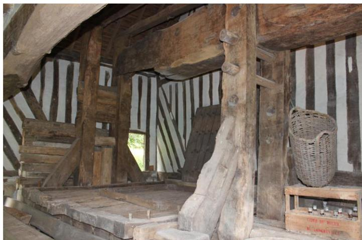
*A gauche, la faisselle ou l'é moy, une plateforme en chêne sur laquelle on installe le marc de pommes dans un cadre carré en chêne. Autour de ce plancher est taillé un sillon permettant au cidre de s'écouler lors de la pressée par la gouttière située devant la faisselle appelée béron.*
